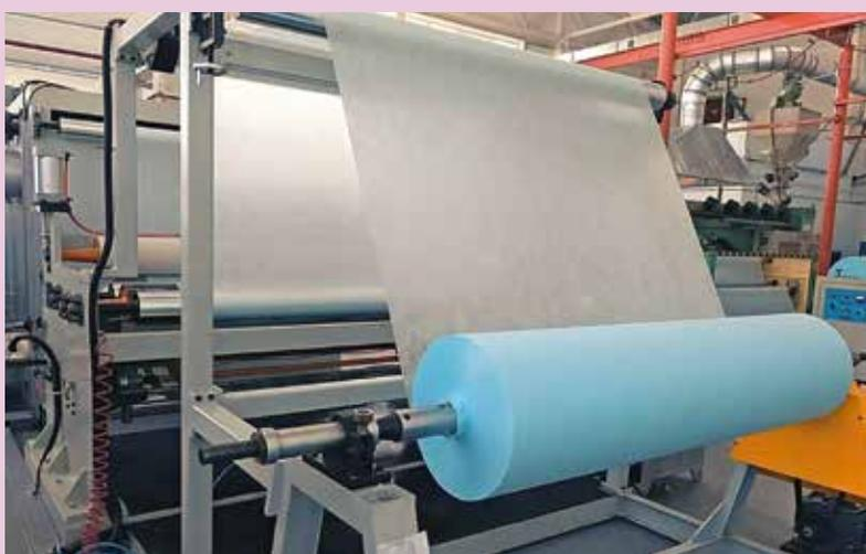
На заводе «Гекса – нетканые материалы» в г. Торжке Тверской области работают автоматизированные линии по производству медицинских масок из собственного спанбонда
