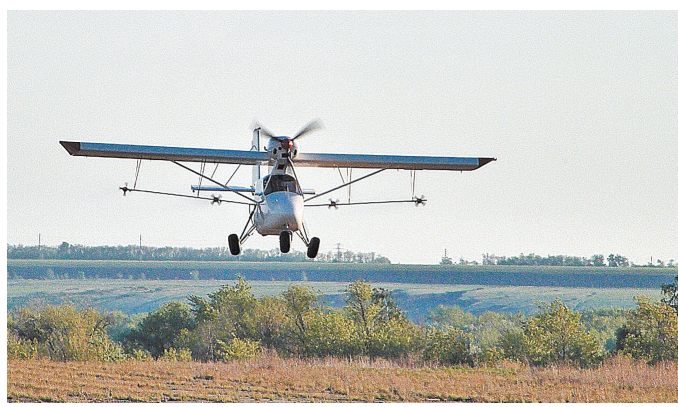
Новый самолет может взять на борт 160 литров химреактивов для обработки посевов от вредителей и болезней.
